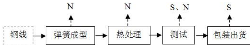
图 3-3 弹簧生产工艺及产污环节流程图
